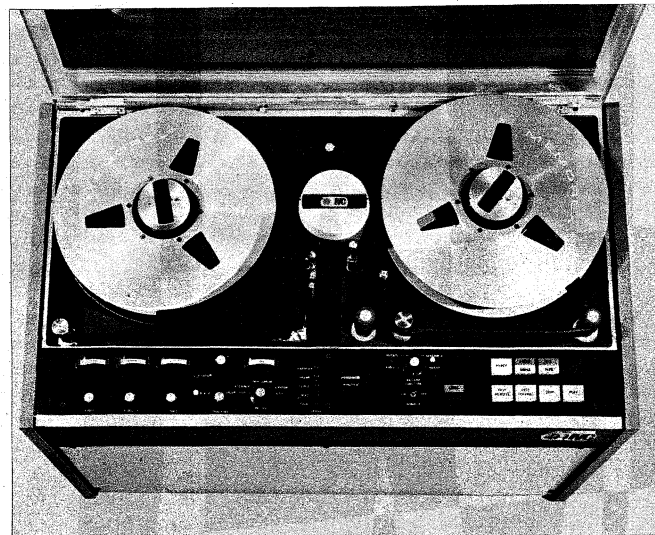
Bild 6. Studiotüchtiger Farbfernseh-Video-recorder, Typ IVC-900, mit Schrägspuraufzeichnung und vollständiger elektronischer Schneideeinrichtung
